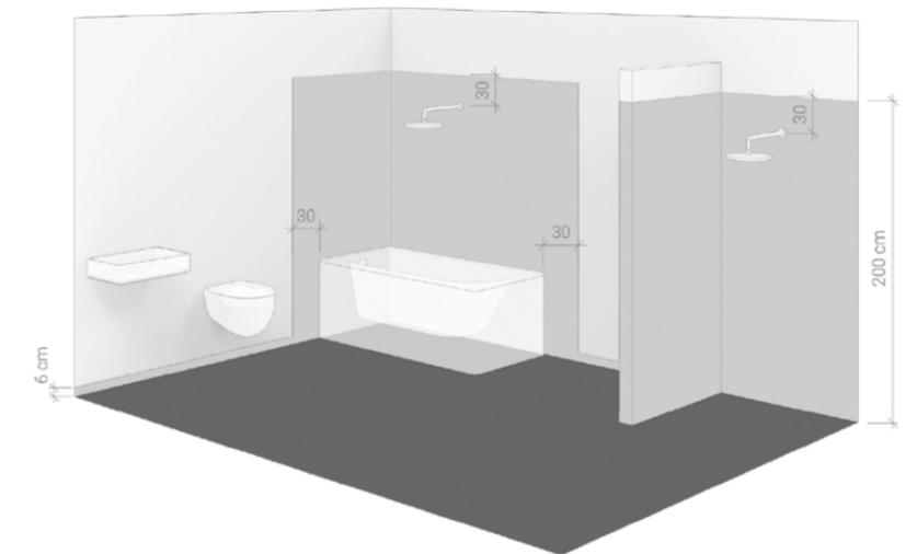
Die Wasserisolierung, die auch als wasserbeständige, feuchtigkeitsbeständige oder wasserabweisende Isolierung bezeichnet wird, schützt den Untergrund vor Wassereinwirkung. Wände müssen bis zu einer minimalen Höhe von 2,0 m abgedichtet werden. Die Wasserisolierung ist mittels Anstrich oder Dichtungsmatte möglich.
