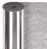
Silent PUR ALU 2 mm Art. A0016009 – Rolle á 8,5 m 2 Trittschalldämmung mit Alukaschierung Trittschall 18 dB
